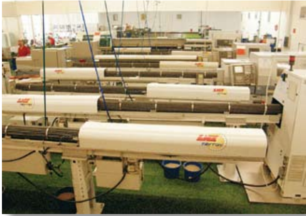
Bild 3: Blick in die Fertigungshalle und auf die LNS TRYTON Hochleistungs-Lademagazine
