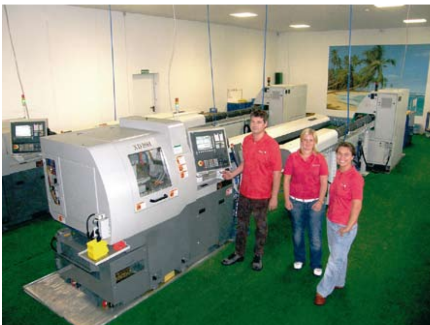
Bild 2: Michael Jehle, Heidi Schulz und Ulrike Brucker mit ihrem neuen Langdreher und angebautem LNS Hydrobar Express 220 Stangenlademagazin
